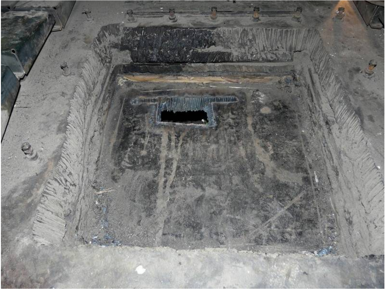
Výřez v horní přední části trupu T-64BV. Viditelná pětivrstvá struktura pancíře z oceli a sklolaminátu
