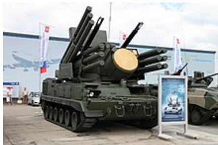
Alternativní montáž protiletadlového komplexu Pantsir-S1 na pásový podvozek GM-352
