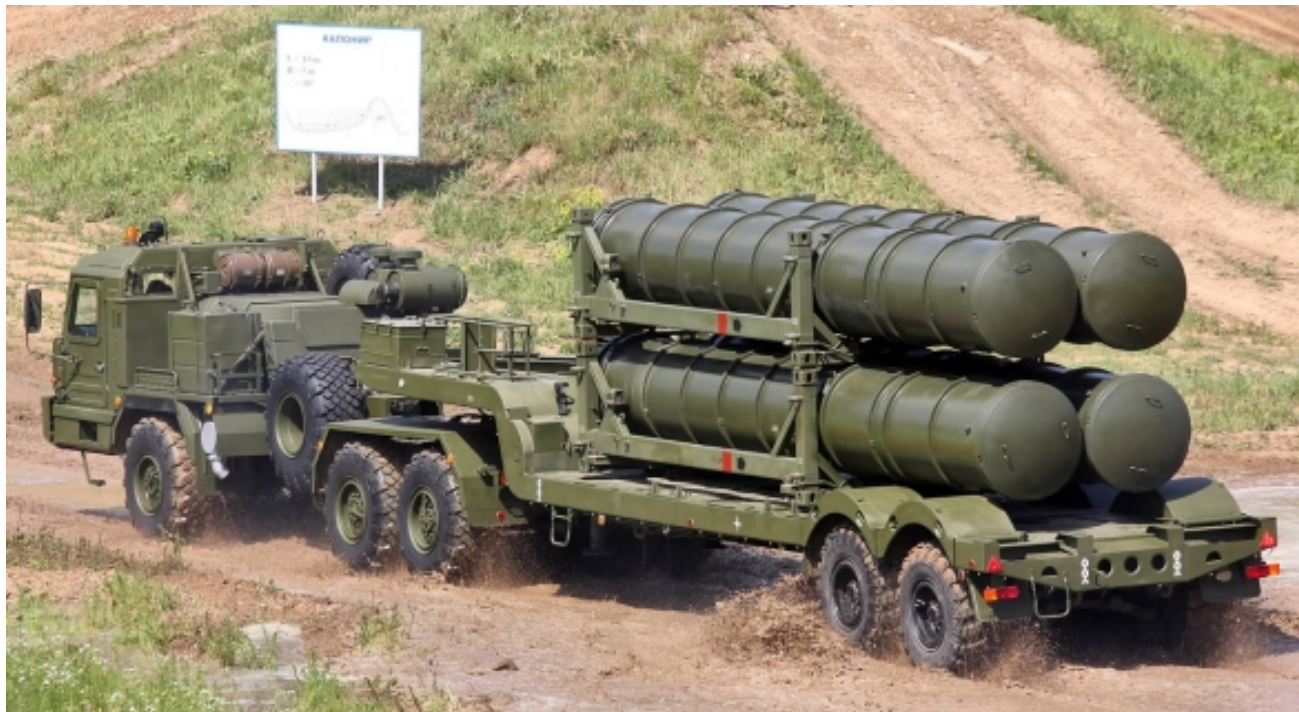
Převavní vůz 5T58-2 na podvozku BAZ-6402-015 raketového systému S-400 s raketami země-vzduch 48N6M; větší foto / Vitalij Kuzmin
