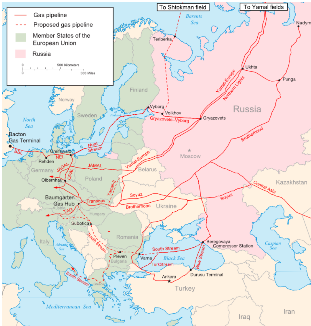
Hlavní plynovody z Ruska do Evropy. / Mapa od Samuela Baileyho / Wikimedia Commons.
