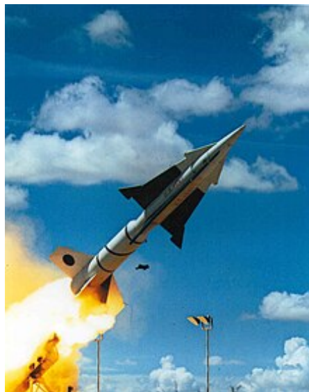
Testovaná střela Nike Zeus A z White Sands ilustruje dlouhá křídla a úzký trup, které se přenesly z Herkula.
