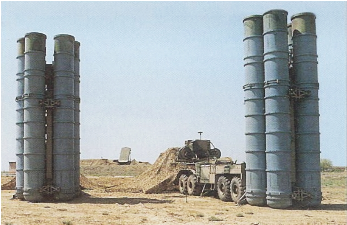
Nasazená baterie S-300PMU2 Favorit / SA-20B Gargoyle. V dálce je viditelný radar pro zapojení klapky 30N6E2 . Tato baterie je propojena pomocí kabelů a teleskopické síťové antény jsou zataženy (RuMOD).
