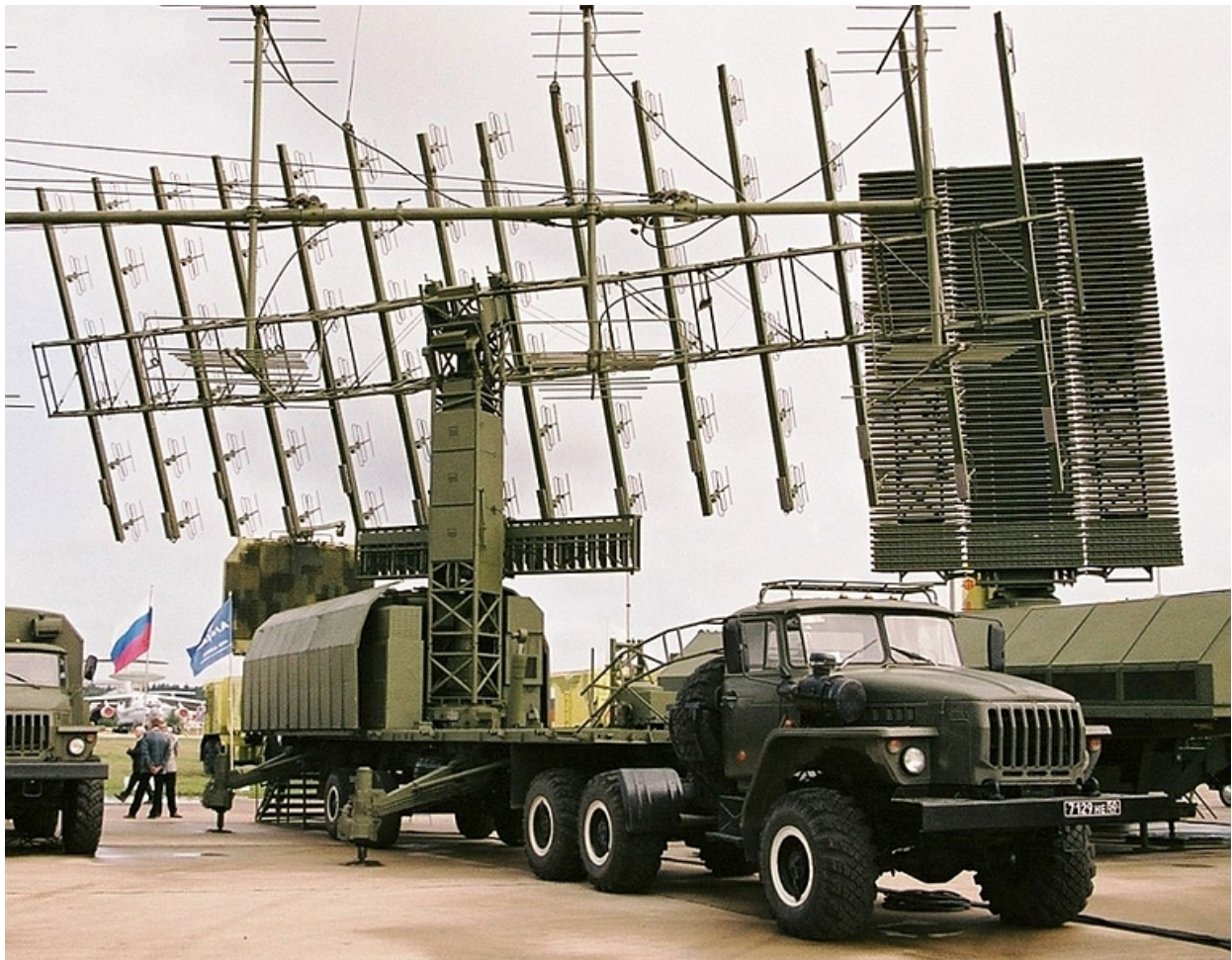
NNIIRT Nebo SVU Ural 4320 varianta taženého návěsu vystavena v nasazené konfiguraci. Budoucí varianty budou pravděpodobně využívat stejný podvozek řady BZKT 8 x 8 jako novější komponentní radary Nebo M (Obrázky © Miroslav Gyűrösi ) .
