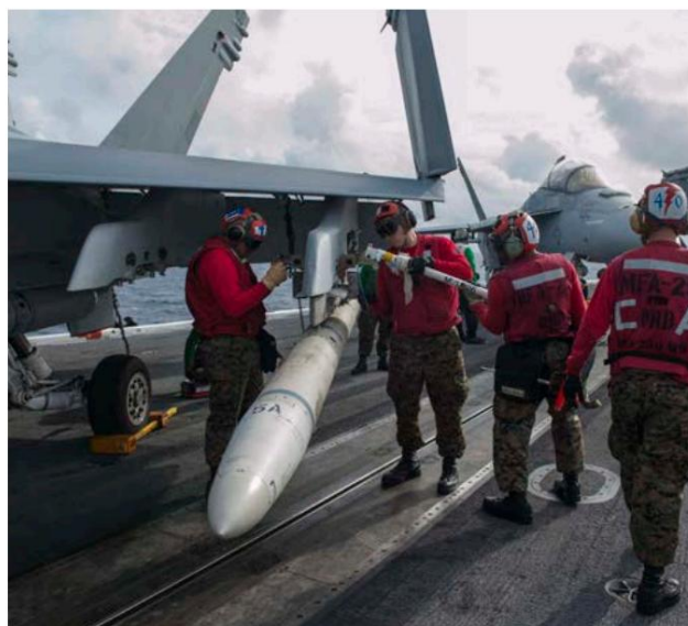
Námořní pěchota přidělená k Thunderbolts of Marine Fighter Attack Squadron (VMFA) 251 odstraňuje cvičný AGM-88 HARM z F/A-18C Hornet na pilotní palubě letadlové lodi USS Theodore Roosevelt třídy Nimitz (CVN 71).
