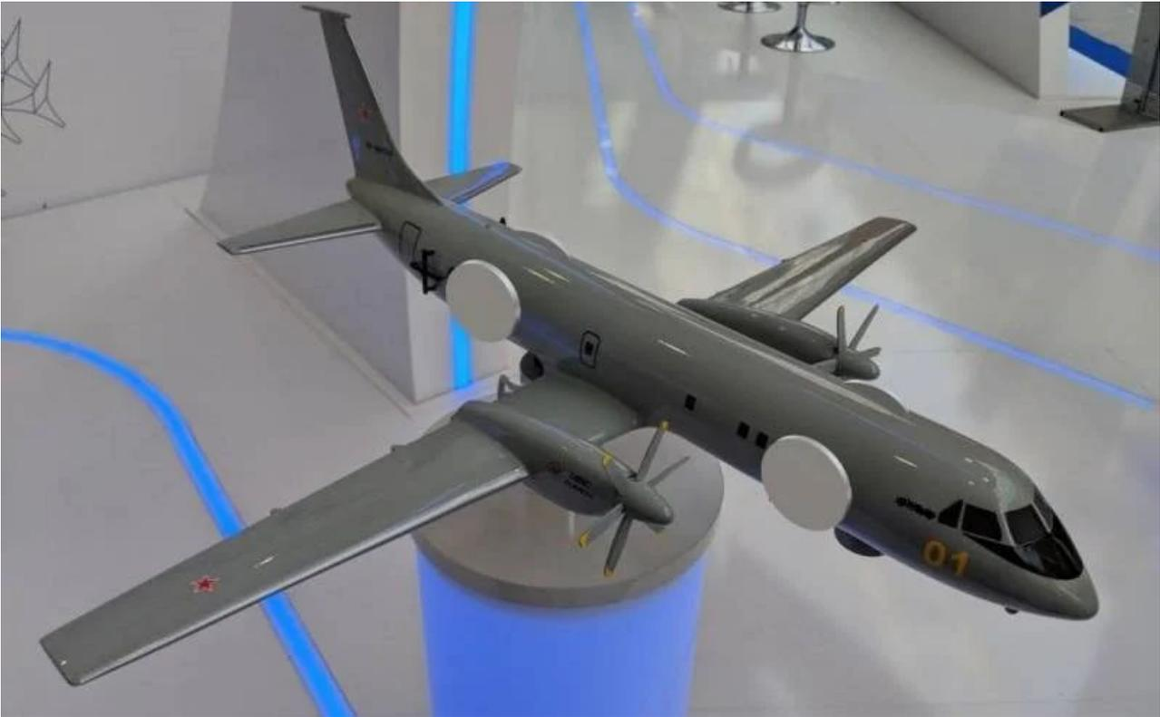
Odhadované umístění na palubě konformních antén radaru Irbis na letounu Tu-114-300
