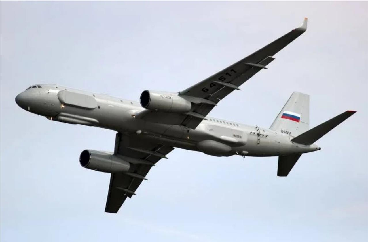
Tu-214R integrovaný radarový, radiotechnický a opticko-elektronický průzkumný letoun
