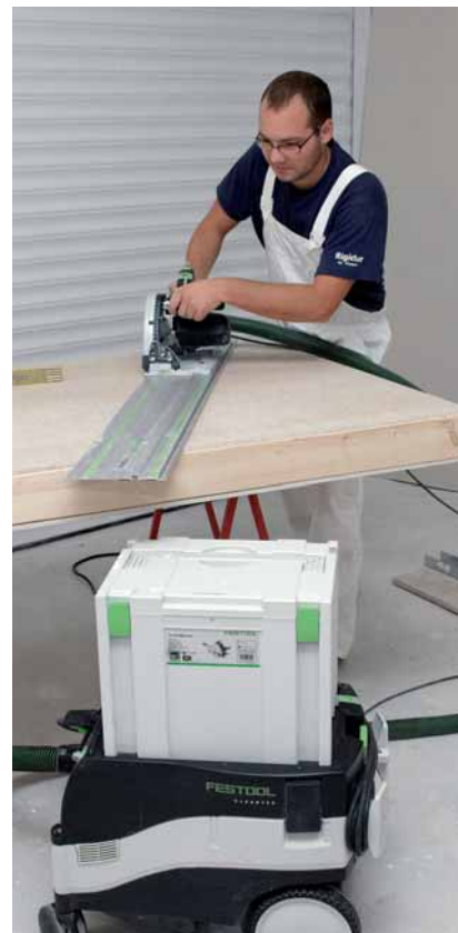
Konstrukční a speciální desky je doporučeno řezat okružní pilou s vodící lištou a odsáváním
