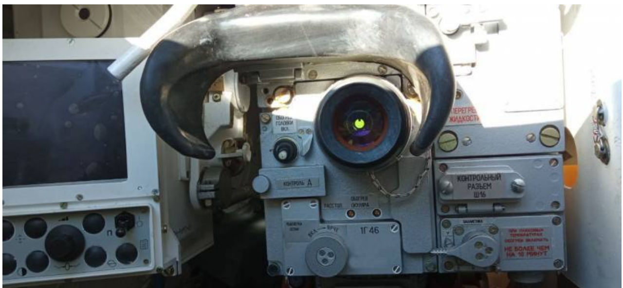
Vlevo displej a ovládací panel termovizního zaměřovače 1PN96MT-02 a vpravo optického zaměřovače 1G46. Tank T-80BVM nový vzorek.
