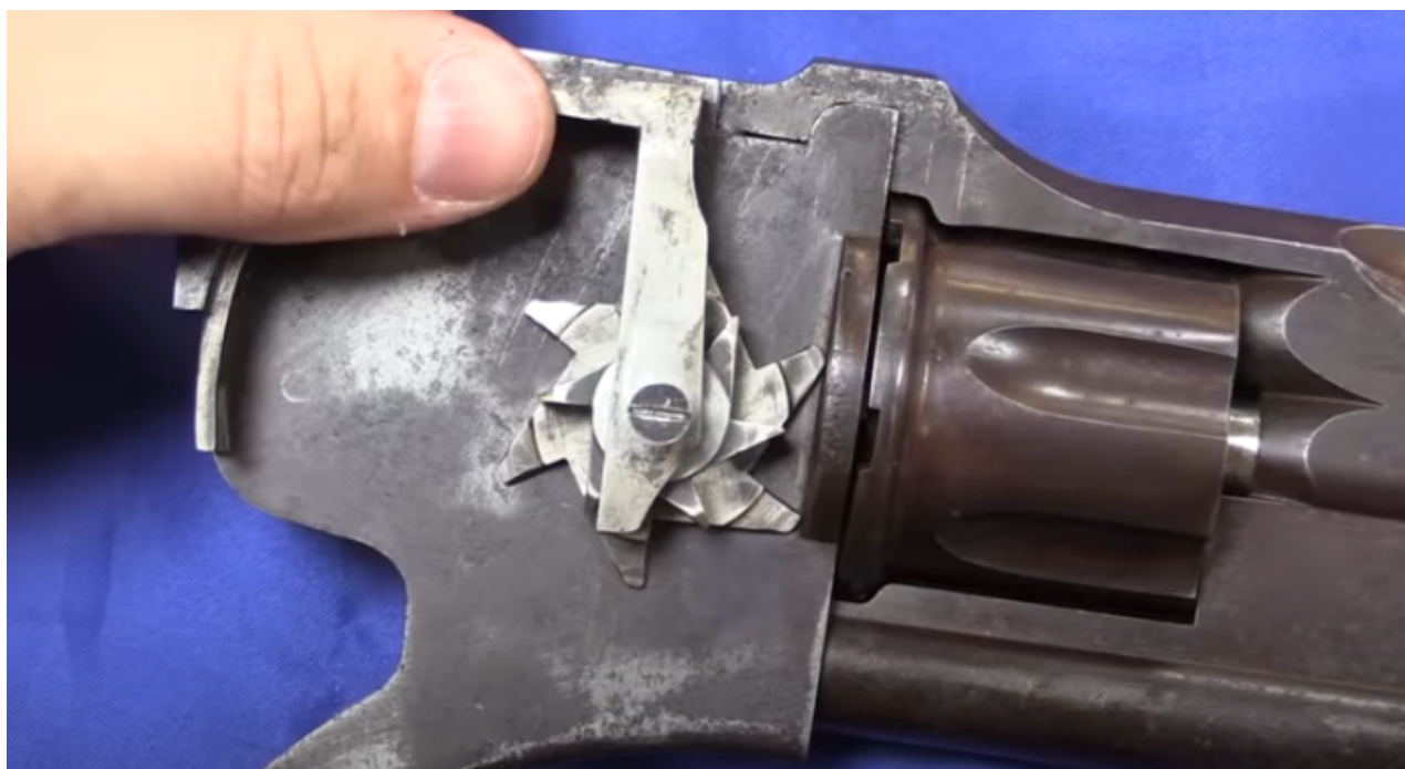
A takto fungovala obě ozubená kola uvnitř zadní části rámu. Větší tlačil na buben, menší stahoval bubeníka. Fotografie zapomenuté zbraně.com
