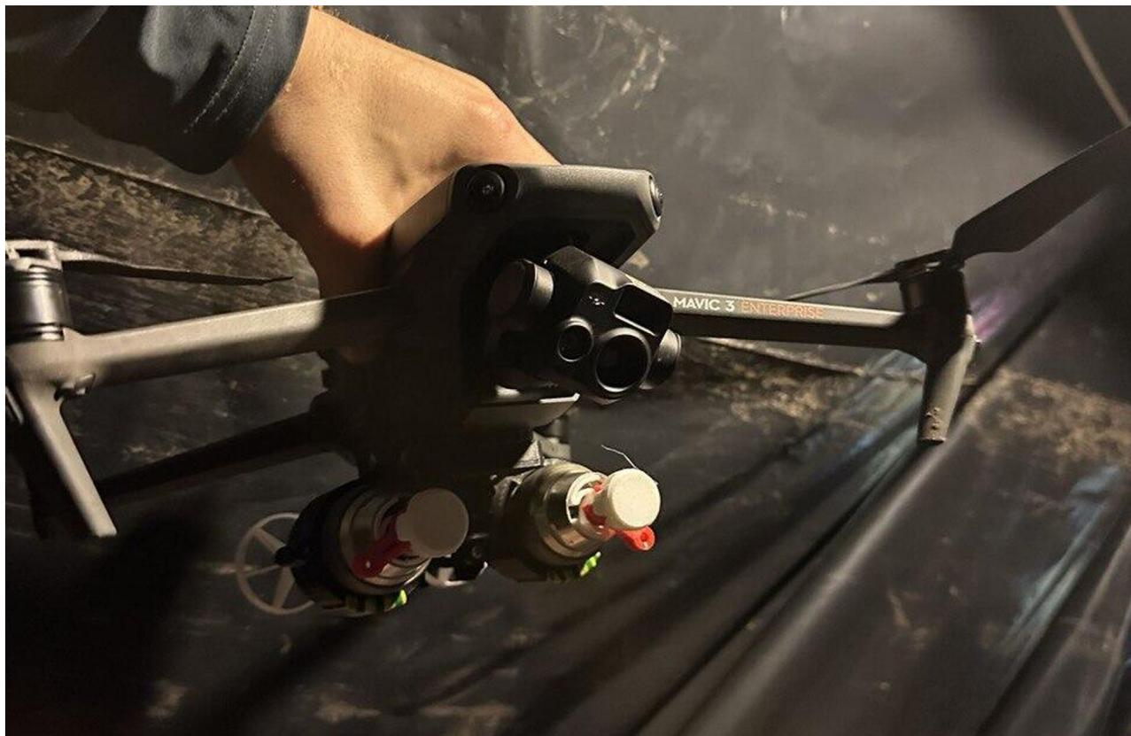
Рыба демонстрирует снаряженный дрон со сбросом
