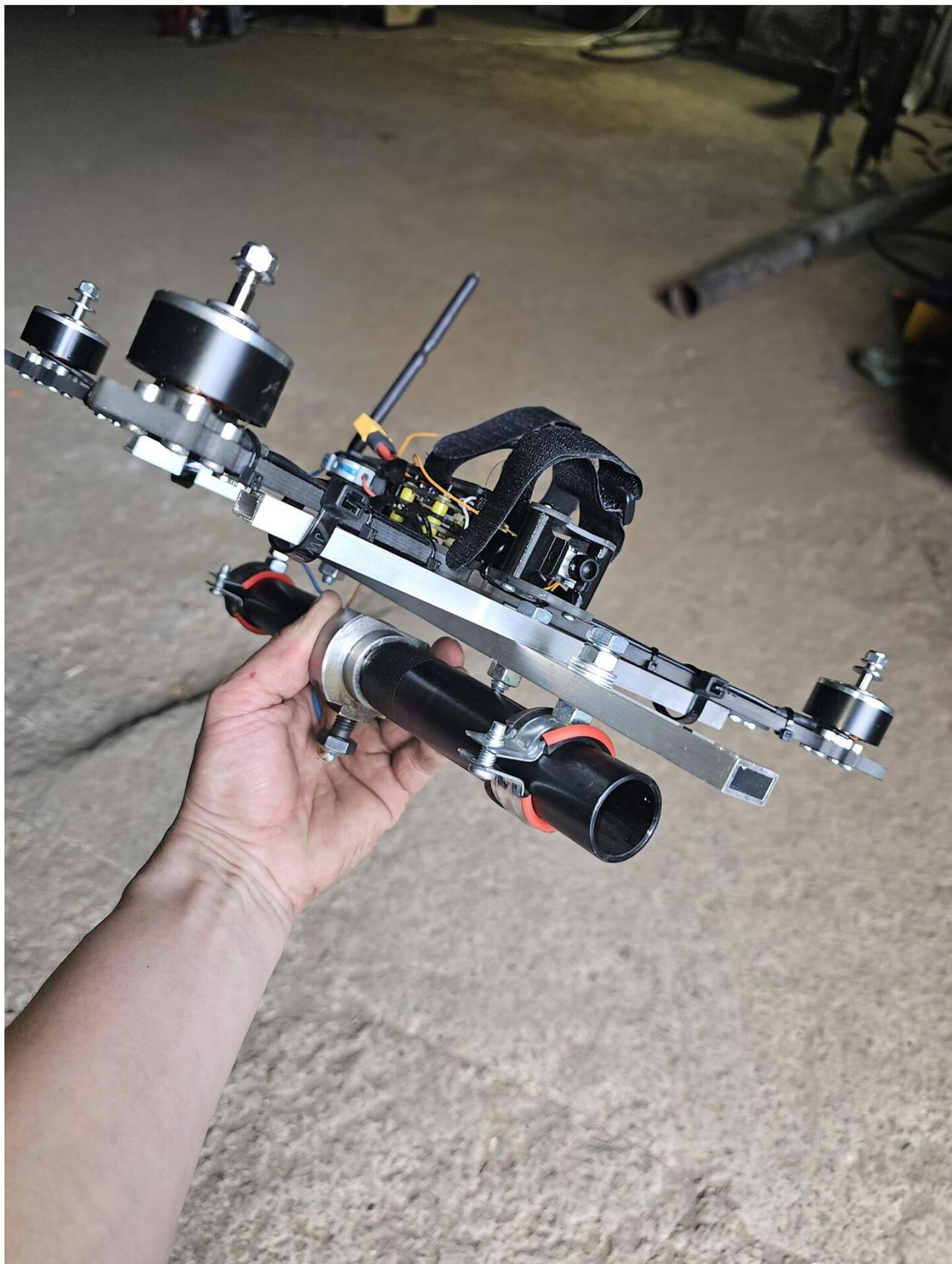
Дрон-истребитель с безоткатным орудием
