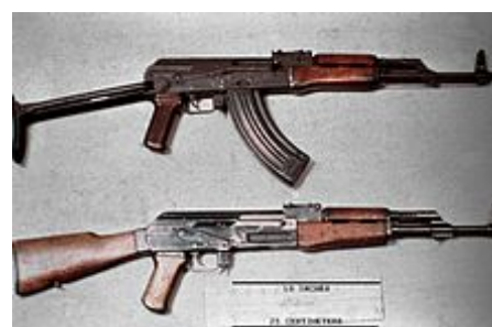
AKMS s lisovaným pouzdem závěru typ 4B (nahore) a AK-47 s obráběným pouzdem závěru typ 2A
