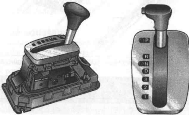
OBR. 146 POHLED NA CELEK VOLICÍ PÁKY ŘAZENÍ A SCHÉMA MOŽNÝCH POLOH VOLICÍ PÁKY
